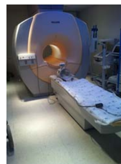
Fig. 3 – Equipamento de Ressonância Magnética de 1,5 T, onde são realizados os exames de RM Fetal. Fonte: Imagem cedida pelo serviço de Imagiologia do HSM - CHLN
